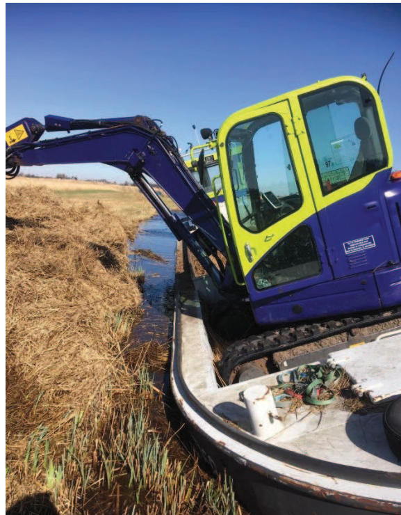
maaisel afvoeren kan spannend zijn; de boot met kraan blijft onder last niet recht liggen.
