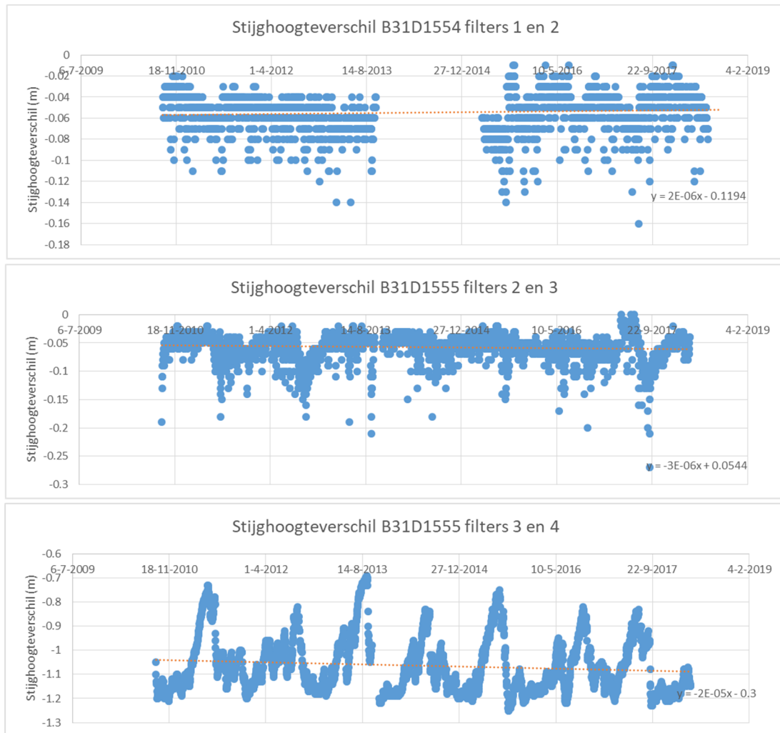
Figuur 6-6. Stijghoogteverschillen tussen de filters in peilbuis B31D1554 en B31D1555. De oranje stippellijnen geven de lineaire trends aan.
