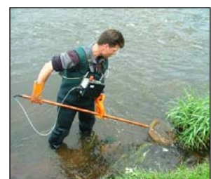
Figuur 2.1. Schematische weergave en foto van elektrovisserij vanuit een boot en foto van visserij met een draagbaar elektrovisapparaat (bron: ATKb)
