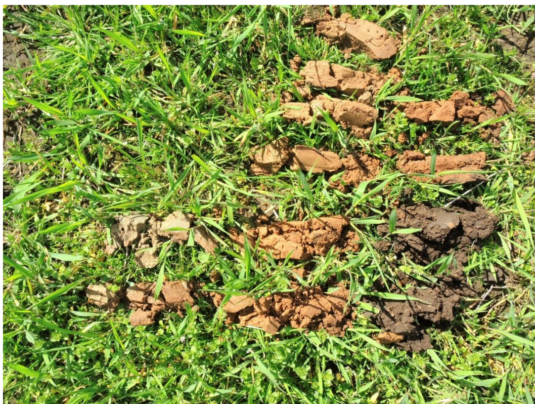
Foto 2 Profiel van de beekeerdgrond die werd gevonden op boorlocatie 26 in Verkooijen. Voor ligging van de boorlocatie zie Figuur 17.
