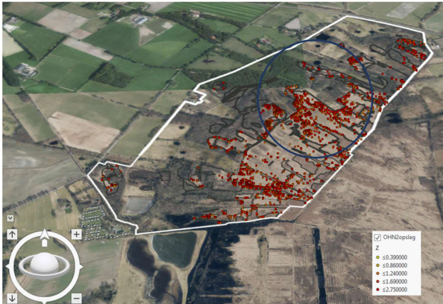
Figuur 4.2 3Dview van Aamsveen met alle AHN2 punten die als 'opslag' zijn geclassificeerd.
