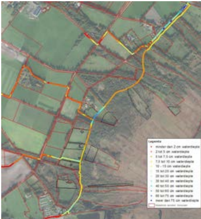
Figuur 8.4 Waterdieptes bij 0,01Q-afvoersituatie (zomersituatie)
