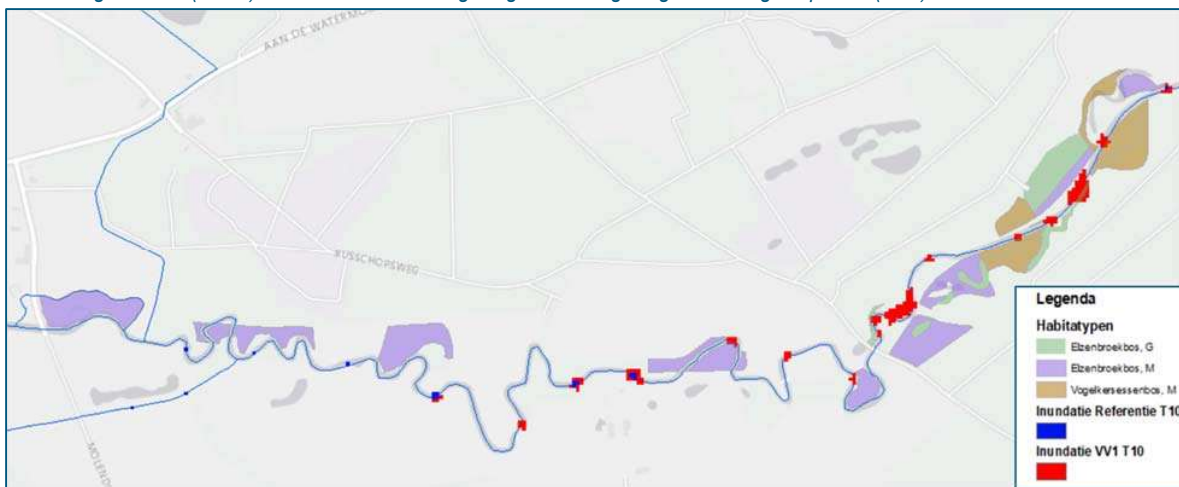
Figuur 7-50: Detailkaart deelgebied 4, Leubeeck stroomopwaarts van Elisabethsmolen. Berekende inundatie bij T=10 hoogwatersituatie. Inundatie in de huidige situatie (blauw) en extra inundatie als gevolg van het afgewogen maatregelenpakket (rood)
