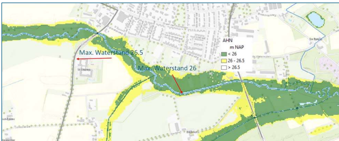
Figuur 7-52: Berekende inundaties bebouwde kern Heythuysen. T=100 hoogwatersituatie. Na uitvoering van het afgewogen maatregelenpakket
