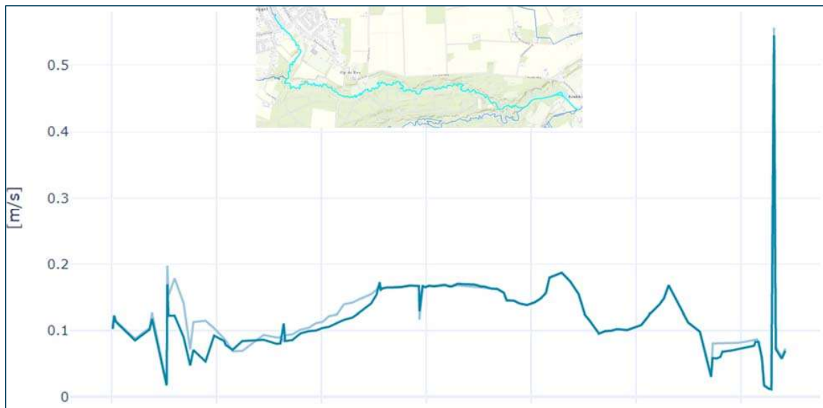
Figuur 7-55: Berekende stroomsnelheid gedurende de zomerperiode in de Roggelse Beek / Zelsterbeek. Huidige situatie (lichtblauw) en situatie na realisatie afgewogen maatregelenpakket (donkerblauw)
