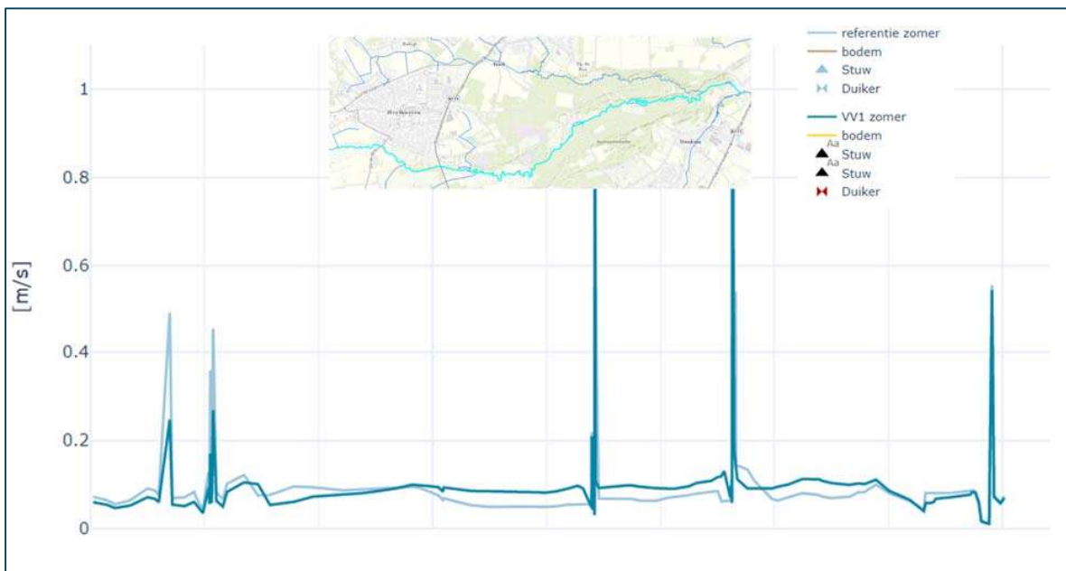
Figuur 7-54: Berekende stroomsnelheid gedurende de zomerperiode in de Tungelroyse Beek / Leubeek / Neerbeek. Huidige situatie (lichtblauw) en situatie na realisatie afgewogen maatregelenpakket (donkerblauw)
