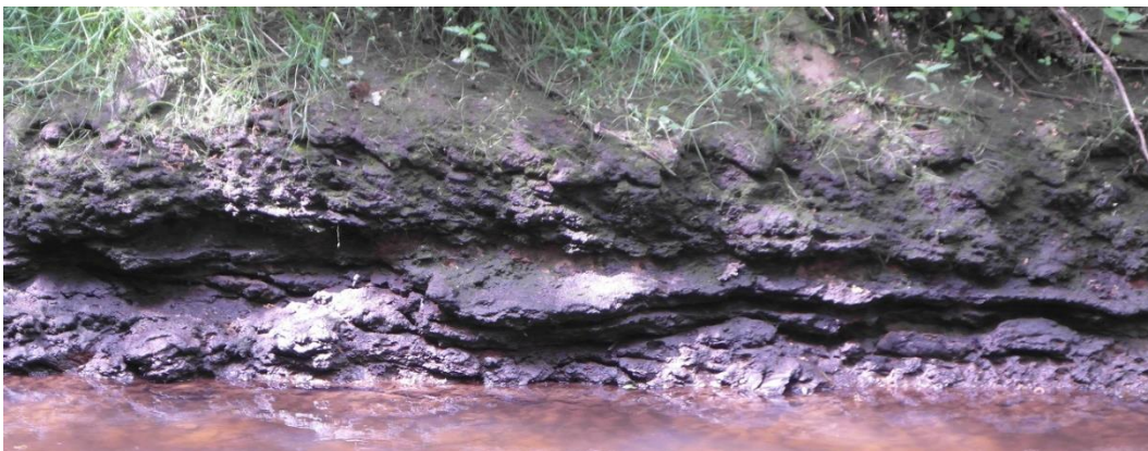
Afbeelding 2.13 Linker oeverprofiel van Leubeek ter plekke van Koebrug met veenbanken. Tijdens opname was het beekpeil relatief laag vanwege openzetten van schuiven bij de St. Ursulamolen.
