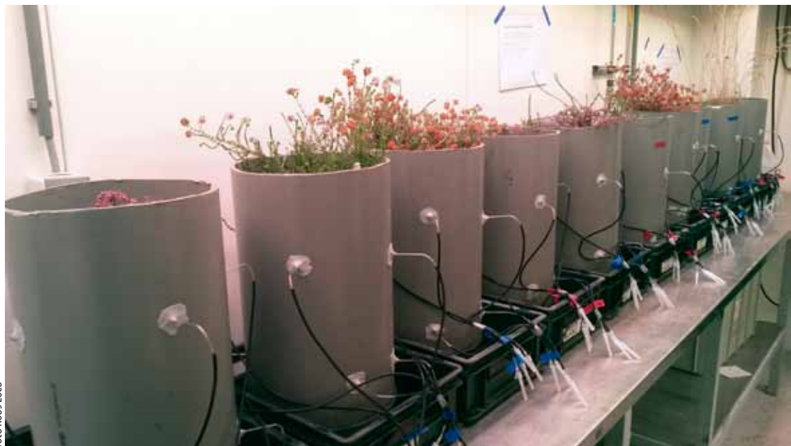
Foto 2. Overzicht van een deel van de proefopstelling in de klimaatkamer (2-1-2019). Duidelijk zichtbaar zijn de rhizonporiewatersamplers op twee dieptes.
