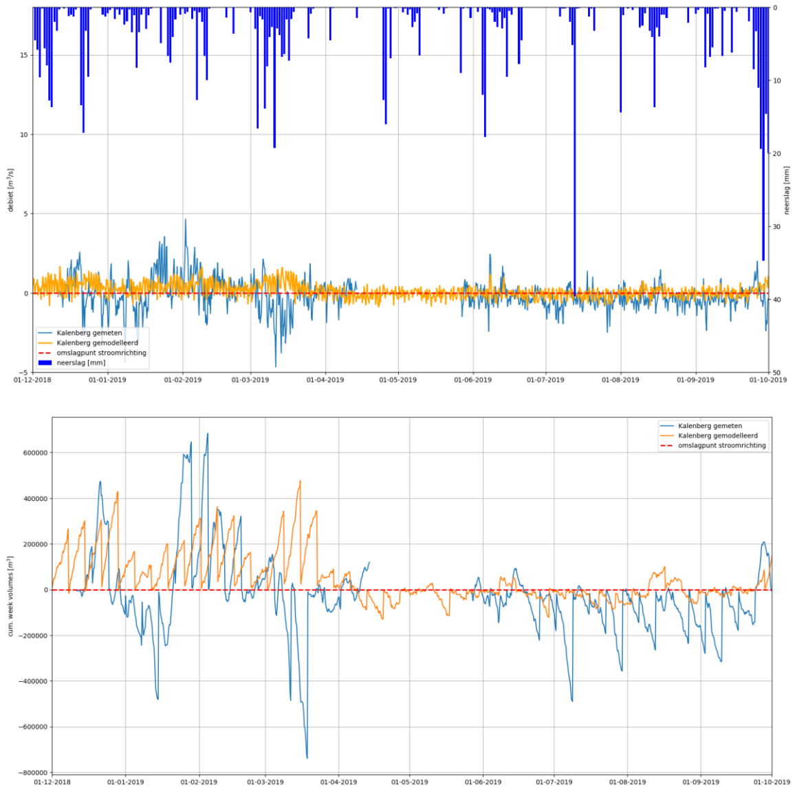
Afbeelding 3.19 Gemodelleerde (oranje lijn) en gemeten (blauwe lijn) debiet bij de locatie Kalenberg. Boven: dagelijkse waarden. Onder: week cumulatieve waarden
