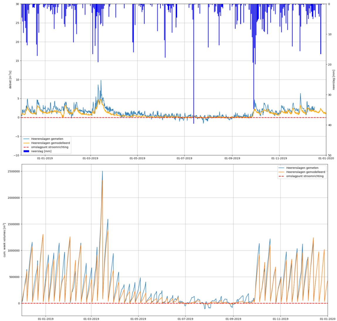
Afbeelding 3.17 Gemodelleerde (oranje lijn) en gemeten (blauwe lijn) debiet bij de locatie Heerenslagen. Boven: dagelijkse waarden. Onder: week cumulatieve waarden
