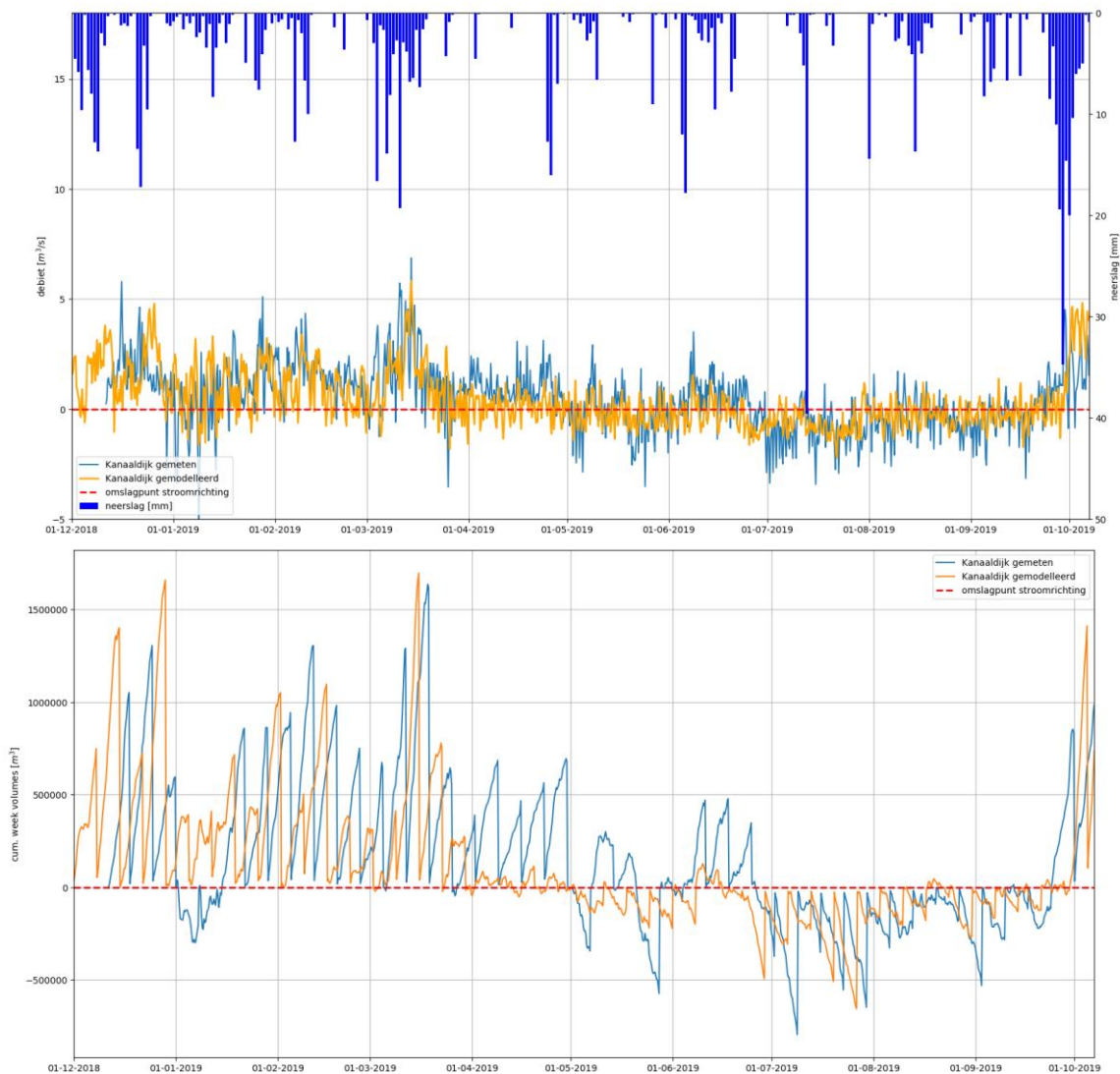
Afbeelding 3.20 Gemodelleerde (oranje lijn) en gemeten (blauwe lijn) debiet bij de locatie Kanaaldijk. Boven: dagelijkse waarden. Onder: week cumulatieve waarden
