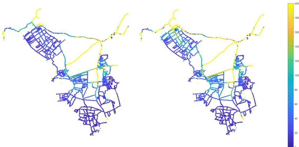
Afbeelding 5.3 Het debiet (mm/dag) in de boezem in het winterhalfjaar. Links: huidige situatie. Rechts: scenario 4
