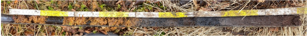
Figuur 3-20. Recente veenvorming direct op een verstoorde zandbodem. Rechts is de oorspronkelijke podzol nog goed te herkennen, de toplaag is verstoord. Daarop is 40 cm recent veenmosveen ontstaan.
