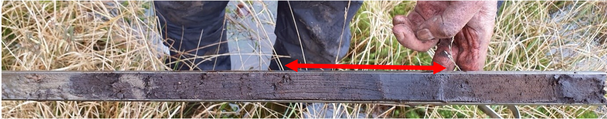
Figuur 3-9. Voorbeeld van een gliedelaag (rode pijl), zowel de Ah, E als deel van de Bh zijn niet meer te herkennen. Alleen de roodbruine Bs is rechts nog zichtbaar. In dit profiel is het veen tot vrijwel op de gliede afgegraven en overstoven geraakt.
