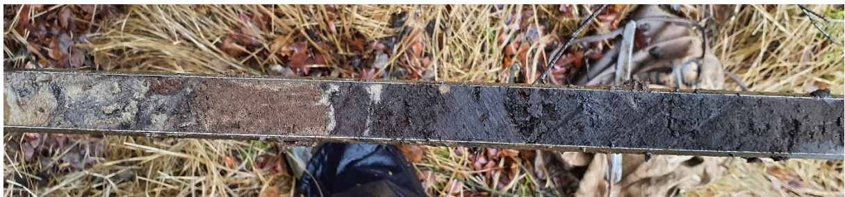
Figuur 3-14. Detailuitsnede uit het zand-veenprofiel in het Bosveen. De zandlagen zijn gestoord en bestaan uit een menging van verschillende bodemlagen en veentypen.
