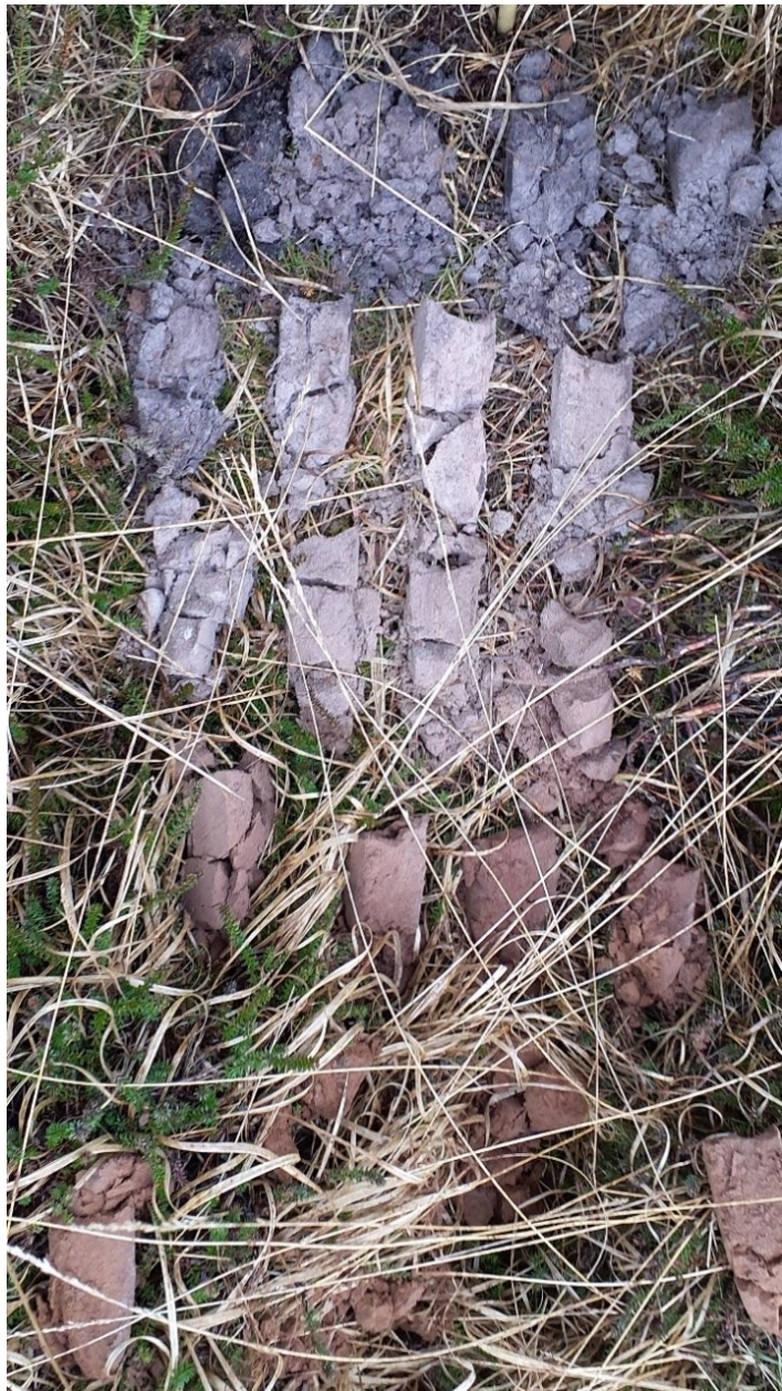
Figuur 3-17. Bodemprofiel bij grondboring 73 in een dekzandrug ten zuiden van het Armveen, met een dikke grijze tot witte uitlogingshorizont en roodbruine inspoelingshorizont, duidend op laterale waterbeweging.
